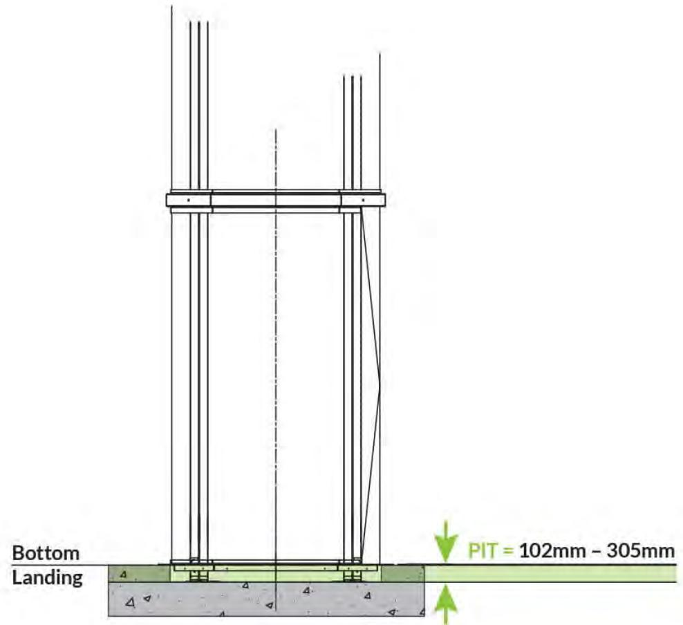
当无法建造底坑时，所有型号均可提供一个可选项的较短坡道。
